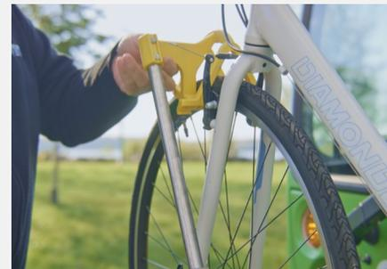
3. Levez le bras d'appui en tirant sur le ressort et déposez-le au plus haut sur le pneu, sans toucher au cadre et au garde-boue du vélo.
