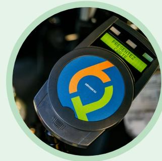
Équipement qui permet la validation automatique du droit de passage à l'embarquement. Les usagers tapent leur **carte CITE** sur le valideur au moment de monter à bord de l'autobus pour déduire un passage du porte-monnaie électronique ou pour utiliser le titre mensuel encodé sur la carte. Si un usager utilise le porte-monnaie électronique pour payer son droit de passage, le valideur affichera automatiquement le solde restant de la carte CITE au moment de la validation.
