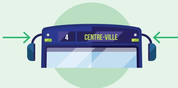
Située à l'avant de l'autobus, la girouette est un afficheur électronique qui expose le numéro de la ligne de transport et sa direction. Il est important de toujours bien vérifier l'information diffusée sur la girouette avant d'embarquer à bord de l'autobus.
